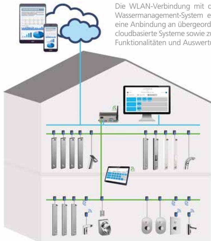
Die WLAN-Verbindung mit dem CNX Wassermanagement-System ermöglicht eine Anbindung an übergeordnete, z.B. cloudbasierte Systeme sowie zusätzliche Funktionalitäten und Auswertungen
