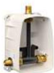
Rohmontageset für **mechanische und elektronische Duscheinrichtung** auf Basis der adaptiven Multifunktions-Wasserstrecke CONGENIAL mit Thermostat, ausgeführt als Unterputz-Dusche in Nennweite DN15. Einsatzbereich im Neubau und Sanierung in öffentlichen, halböffentlichen und gewerblichen Sanitärräumen.
