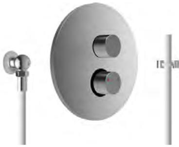
Hydrotherapie-Garnitur für Kneipp'sche Güsse, mit Verbrühungsschutz und integriertem Absperrventil, mit Möglichkeit zur manuellen thermischen Desinfektion, Schlauch 2400 mm, Weiss, für Wandeinbau, zum Anschluss an Kalt- und Warmwasser.
