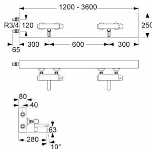
lino Reihenwaschplatzverteiler W35, mit IR-Sensor, mit Thermostat
